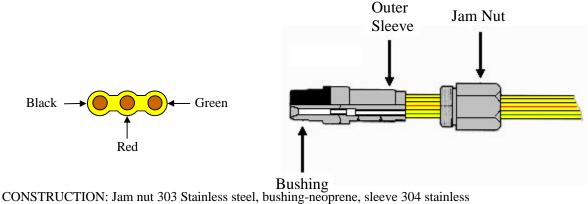
CONDUCTORS: 12 AWG 19 x 0.0185"
